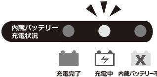
「内蔵バッテリー充電状況」の充電中インジケータ(赤)が点灯して、充電が開始されます。
