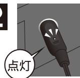
シガープラグ部分のランプが赤く点灯すれば車両とケーブルの接続完了です。
