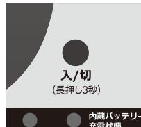
MS2のスイッチを入れて(電源ボタン長押し3秒)、「内蔵バッテリー充電状態」のインジケータが「50～75%」もしくは「75～100%」のところで点灯することを確認してください。
