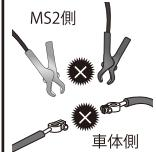
⚠ MS2にケーブルが接続された状態でのクランプ同士の接触、または車体側ケーブル(赤側)が車体やその他金属に接触しないよう十分注意してください。
